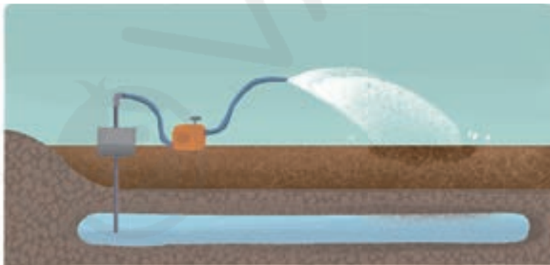
Sumur bor berfungsi mengambil air tanah untuk membasahi lahan gambut.
